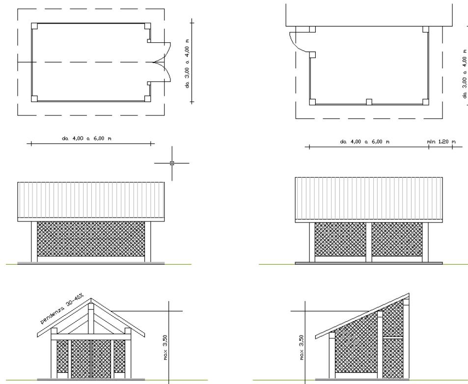
**STRUTTURA:** montanti e travi in legno mordentati con tonalità medie-scure.
